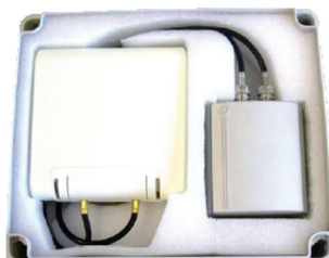
4080 IP-DECT AP mit externer Antenne in Outdoor-Box
